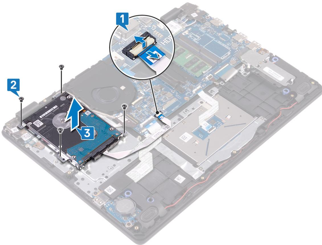
4. Desconecte la unidad mediadora del ensamblaje de la unidad de disco duro.
