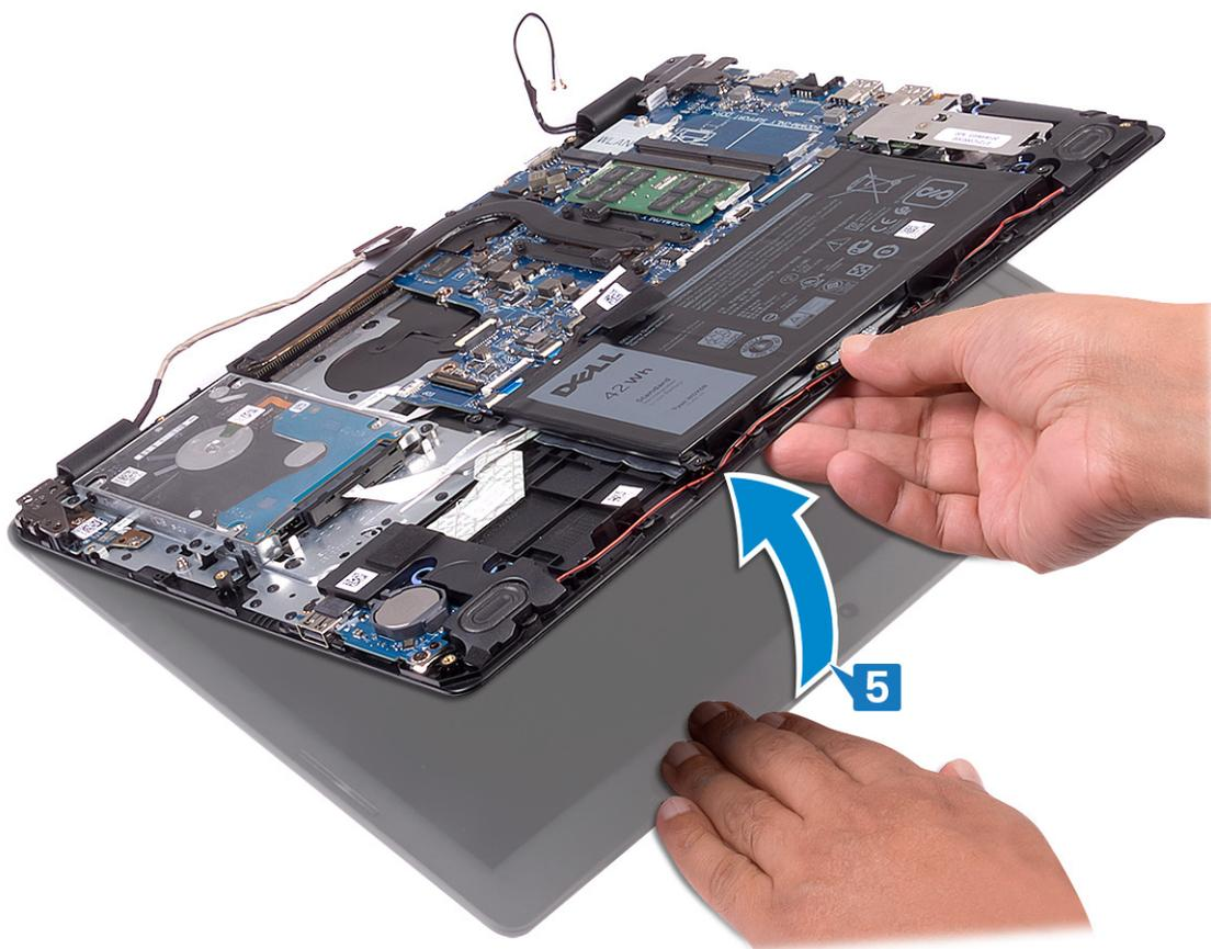
6. Deslice el ensamblaje del teclado y el reposamanos y quítelo del ensamblaje de la pantalla.
