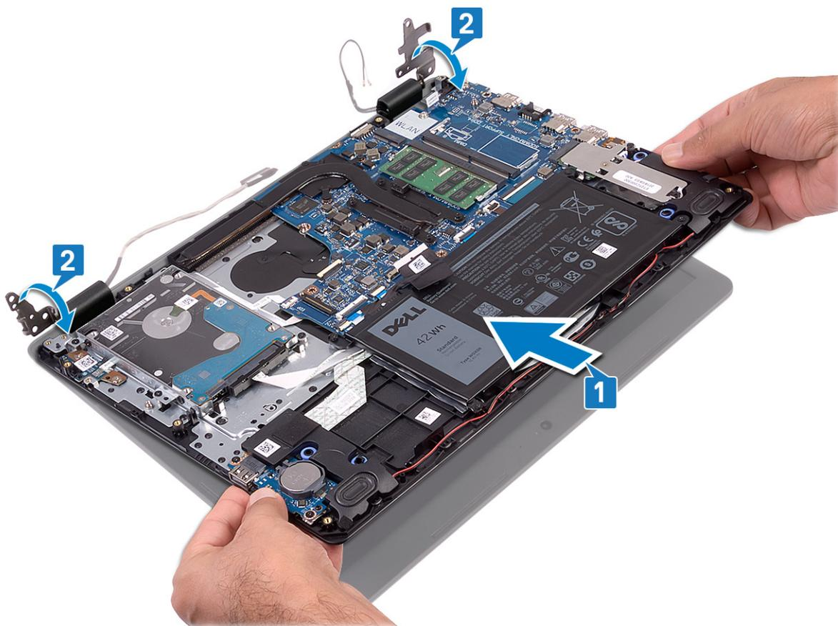
3. Reemplace los cuatro tornillos (M2.5x4) que fijan las bisagras de la pantalla a la placa de E/S y la tarjeta madre del sistema.
