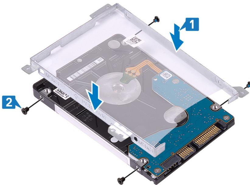
3. Conecte la unidad intermedia al ensamblaje de la unidad de disco duro.
