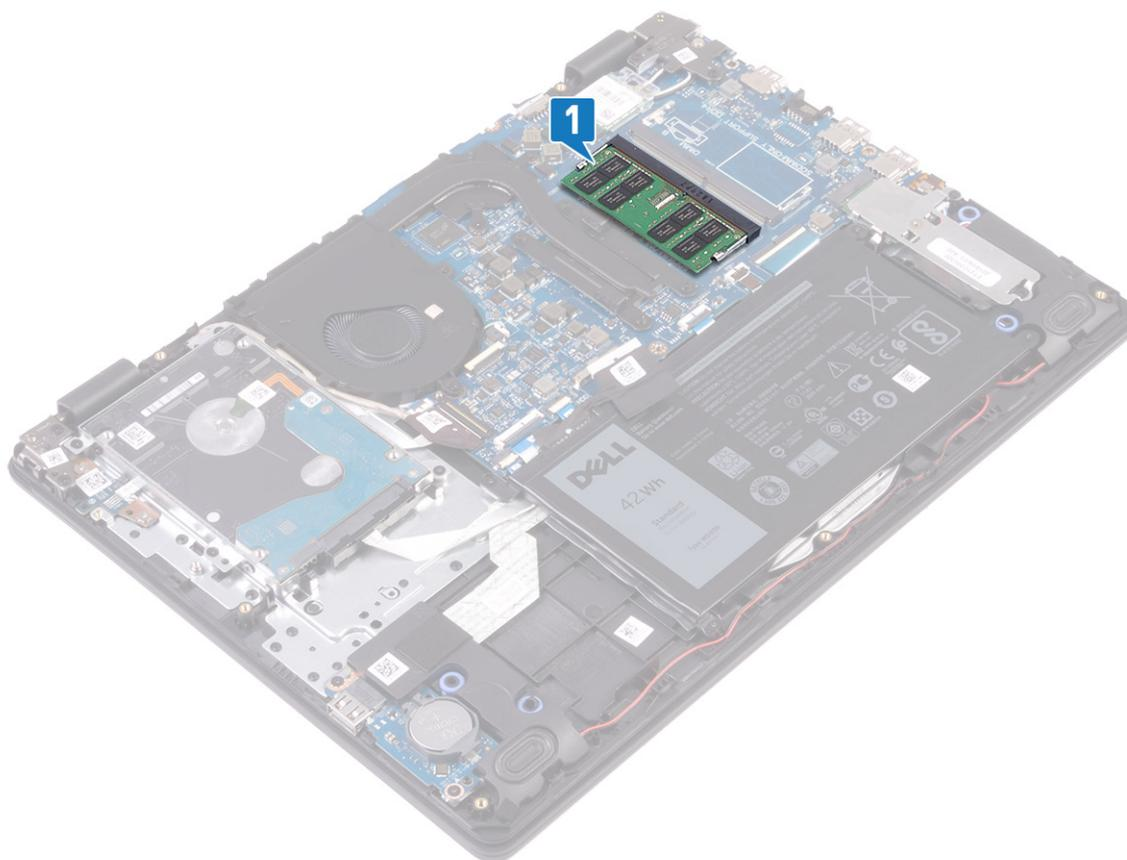
2. Abra con cuidado con la punta de los dedos los ganchos de fijación situados en los extremos de la ranura del módulo de memoria hasta que salga el módulo de memoria.
