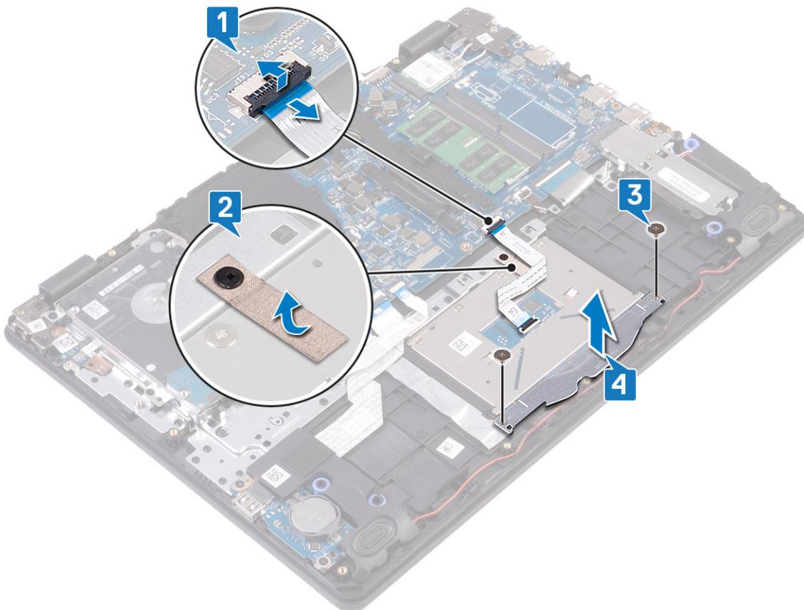
5. Quite los cuatro tornillos (M2x2) que fijan la almohadilla de contacto al ensamblaje del teclado y el reposamanos.
