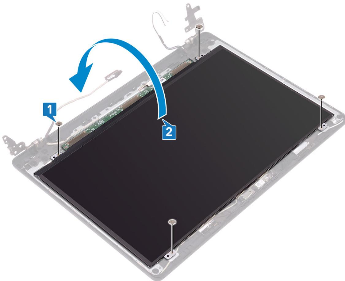
3. Despegue la cinta que fija el cable de la pantalla a la parte posterior del panel de la pantalla.
