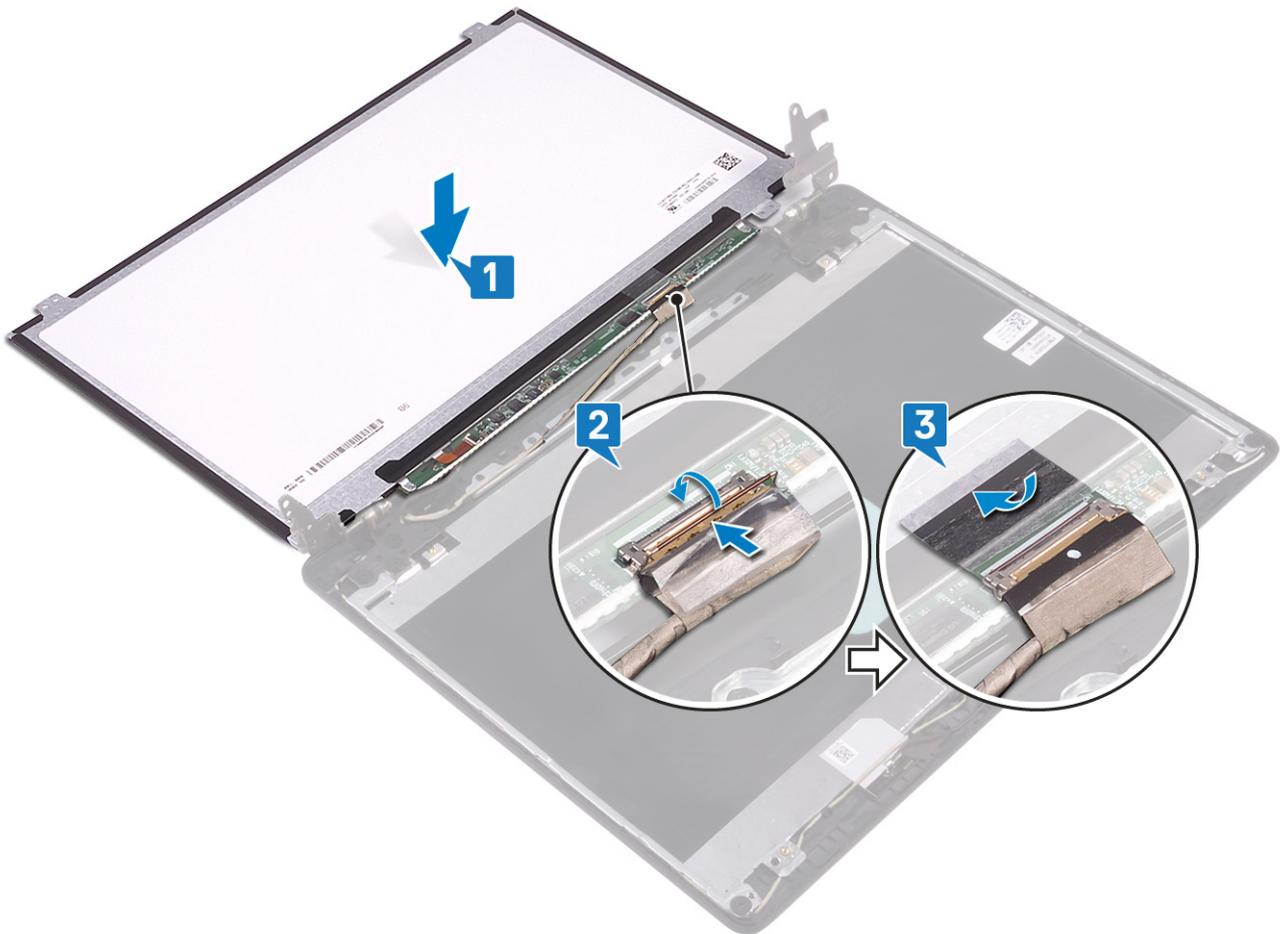
4. Dé la vuelta al panel de la pantalla y colóquelo en el ensamblaje de la antena y la cubierta posterior de la pantalla.
