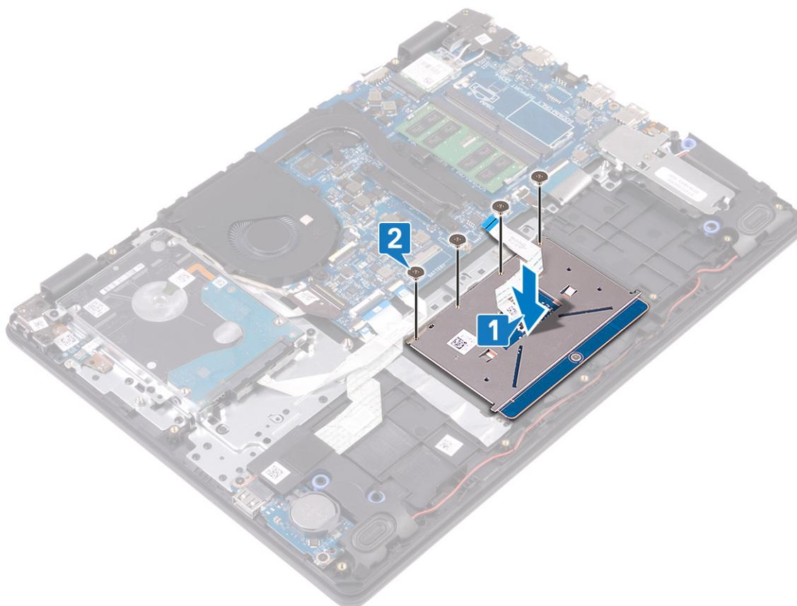
3. Coloque el soporte de la almohadilla de contacto en la ranura del ensamblaje del teclado y el reposamanos.
