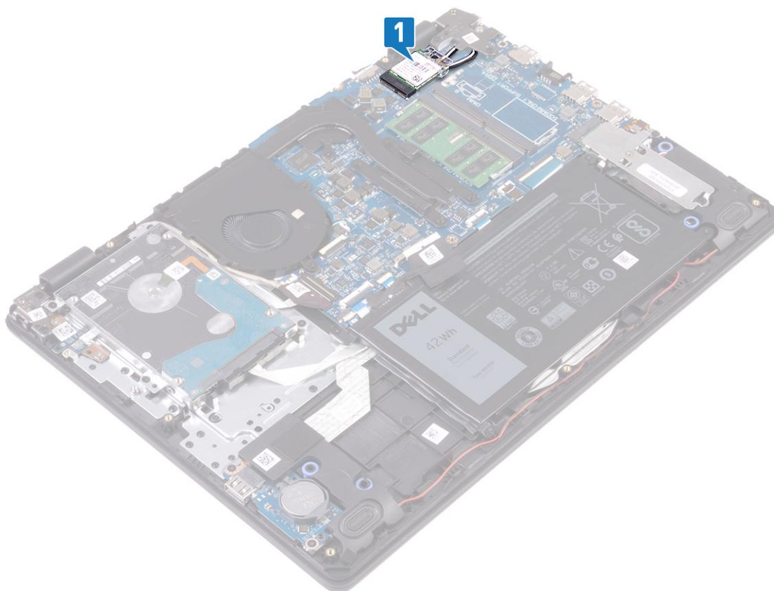
2. Extraiga el tornillo (M2x3) que fija el soporte de la tarjeta inalámbrica a la placa de sistema.
