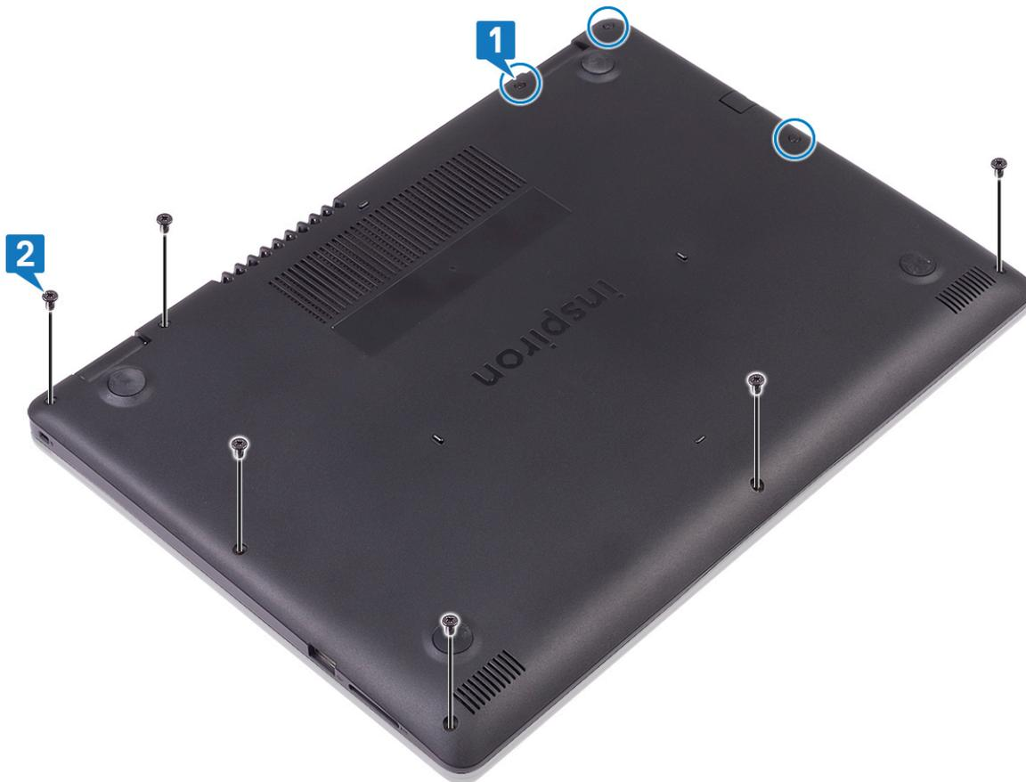
3. Haga palanca en la cubierta de la base desde la esquina superior derecha del ensamblaje del teclado y el reposamanos.
